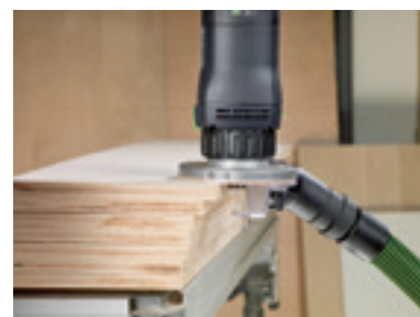
Фрезерование пластмассовой или деревянной кромки.
