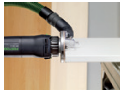
Скругление пластмассовой или деревянной кромки.
