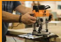
В комплект поставки входит увеличенная платформа для работы по направляющей или кругового фрезерования
