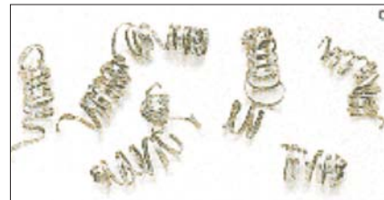
Свободно намотанная (витая) стружка – идеальные условия резания
