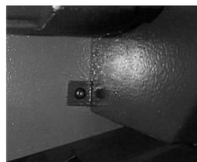
Выкрутите 4 винта с верхней панели, 1 винт из передней панели, 8 винтов из защитного кожуха.
