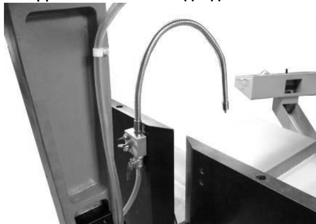
Станок оснащен дополнительным шлангом подвода СОЖ в зону резания, который установлен с передней части неподвижной губки тисков. Это устройство может быть снято и переставлено на заднюю часть неподвижной губки, если это необходимо для удобства работы при повороте пильной рамы.
