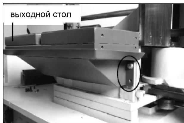
2. Установите концевой упор с правой стороны выходного стола и зафиксируйте его при помощи 4-х винтов.
