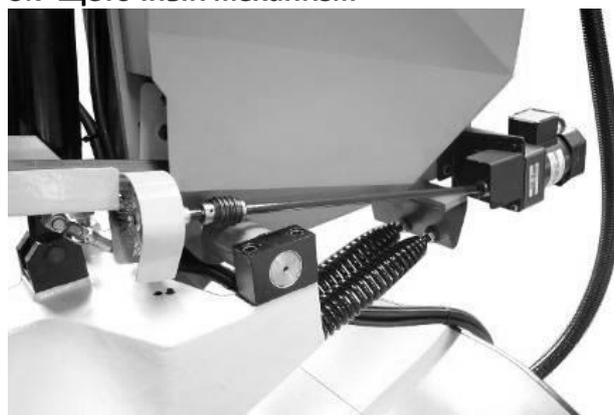
Станок оснащен щеточным механизмом, привод которого осуществляется от осевой передачи приводного двигателя. Щетка необходима для очистки полотна от стружки во впадинах зубьев ленточного полотна для увеличения срока его службы.
