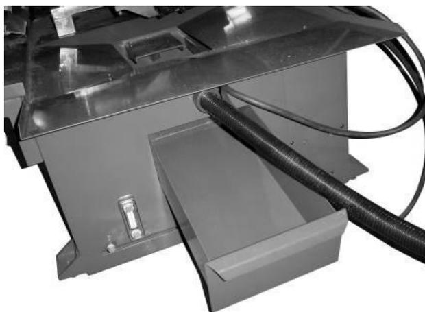
Съемный поддон для сбора стружки и обрезков.
