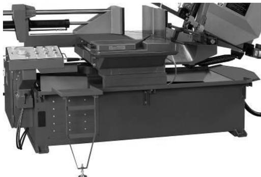
На станине размещены: пильная рама (ось наклона рамы и система относительной блокировки), тиски, система подвода СОЖ, поддоны.
