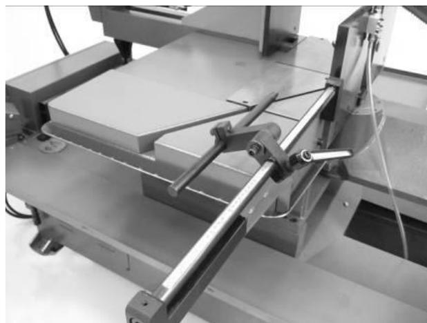
3. Если необходимо выполнить пиление под углом с поворотом рамы на оператора или при обратном распиле, то для удобства работы можно снять со станка съемную крышку переднего стола с левой стороны, потянув ручку вверх и наружу, как показано стрелками на рисунке.
