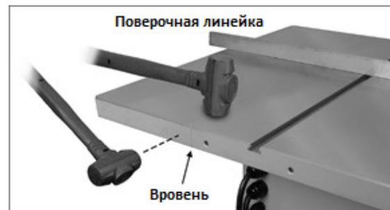
Рис. 6-4: Выравнивание удлинений стола, способ 1
