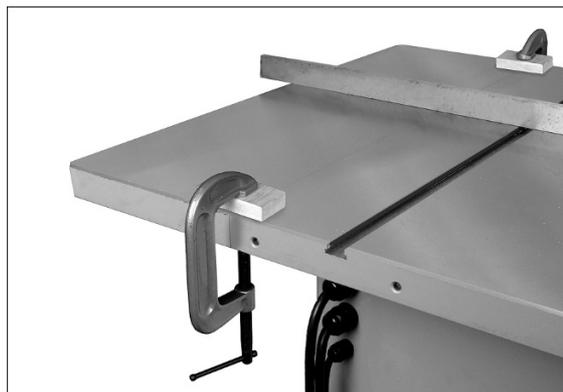
Рис. 6-5: Выравнивание удлинений стола, способ 2
