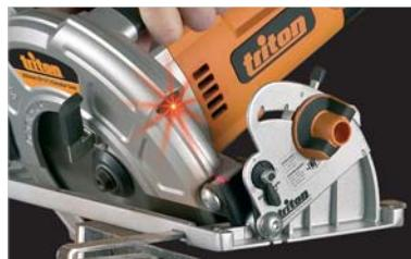
Механизм регулировки угла наклона оснащен вспомогательной рукояткой для юстировки в небольших пределах, что облегчает тонкую настройку
