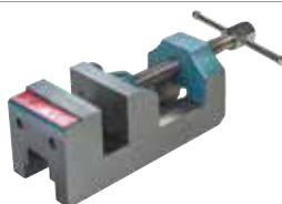
Тиски общего использования для работы на сверлильных станках. Отшлифованные три грани тисков позволяют устанавливать их в любом необходимом положении.
