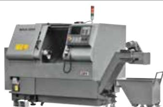
Токарные обрабатывающие центры с наклонной станиной и направляющими качения
