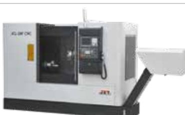
Токарные обрабатывающие центры с наклонной станиной и направляющими качения
