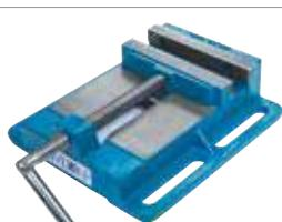
Стационарные тиски для сверлильных работ. Тиски легко монтируются и, благодаря отшлифованной поверхности и 4 пазам для крепления, надёжно фиксируются на рабочий стол станка. Корпус изготовлен из чугуна. Удобная шарнирная ручка помогает надёжно фиксировать заготовку.
