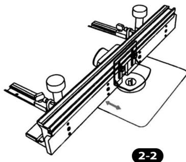
Теперь вы можете точно настроить отступ параллельного упора относительно фрезы. Для этого заблокируйте ручку фиксации механизма точной настройки (а) управления и ослабьте большую ручку (b) (рис. 2-3). Теперь для точной регулировки поверните медную гайку механизма точной настройки, чтобы направляющая перемещалась влево или вправо (рис. 2-4). Диапазон регулировки составляет около 10 мм. После регулировки заблокируйте большую ручку (b) (рис. 2-3).
