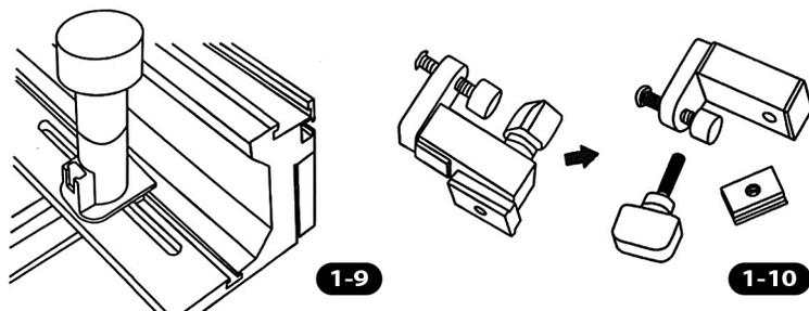
Установите сухарь механизма точной настройки в паз и соедините этот механизм с ручкой как показано на рис. 1-11 и 1-12.
