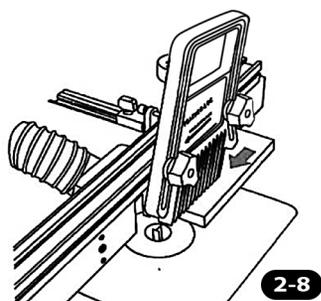
Для максимально безопасной и удобной работы на параллельный упор можно установить гребенчатые прижимы **WOODWORK SPH-002** (приобретаются отдельно) (рис. 2-8).
