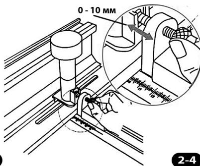
Отрегулируйте высоту фрезы, включите фрезер и пылеудаление. Подавайте заготовку не спеша, надежно прижимая ее одновременно к столешнице и щечкам параллельного упора (рис. 2-5). С помощью нашего параллельного упора вы можете удобно и максимально безопасно фрезеровать пазы, фанки, различные профили, а также выполнять другие операции по фрезеровке (рис. 2-6).
