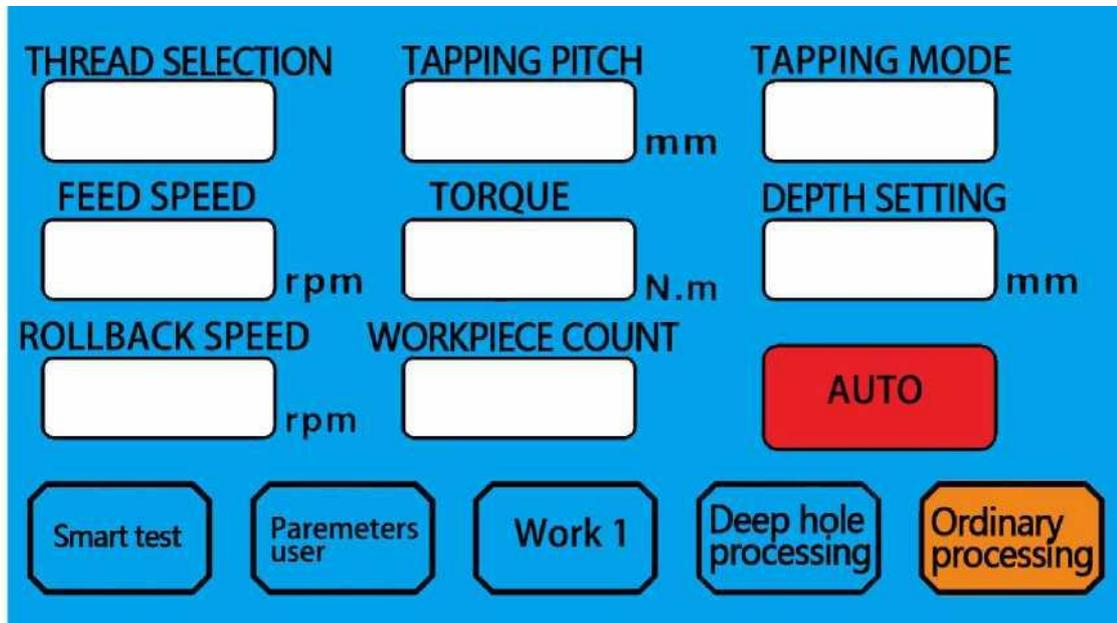
(1) Thread selection (Выбор резьбы): нажмите, чтобы выбрать размер винтовых зубьев для нарезания резьбы, можно переключаться между метрическими и дюймовыми значениями.
