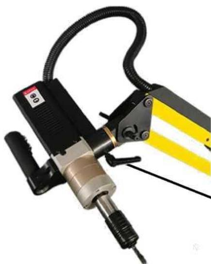
Ослабьте винт, чтобы отрегулировать угол нарезания резьбы. Отрегулировав, зафиксируйте винт.
