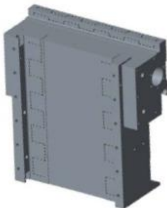
Рис. 5: Схематическое изображение скользящего блока
