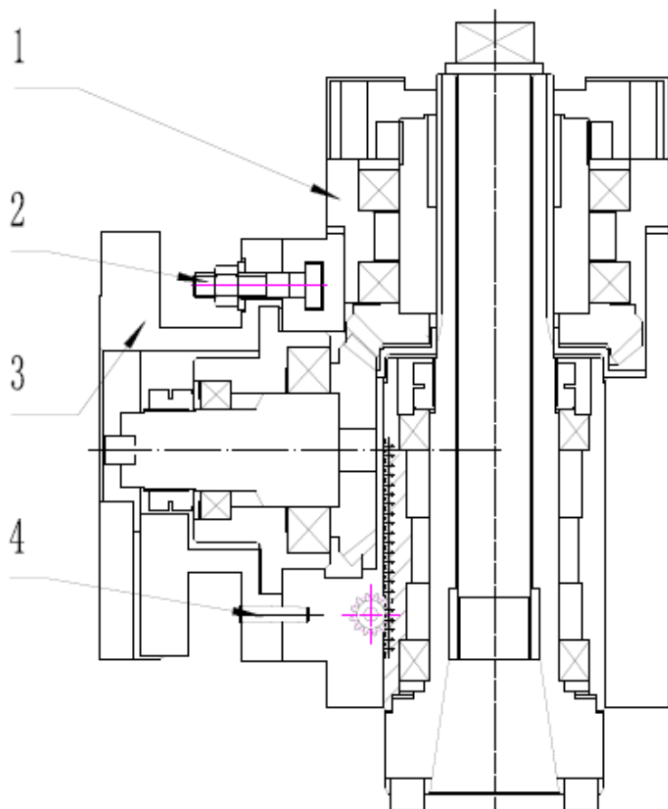
Рис. 18: Регулировка угла фрезерной головки
