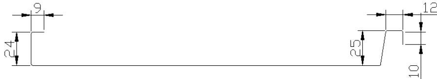
Для сохранения формы готового профиля необходимо на пути следования выходящей из станка панель «картины» установить через каждые 3 метра деревянные козлы, на которые укладывались бы готовые изделия.
