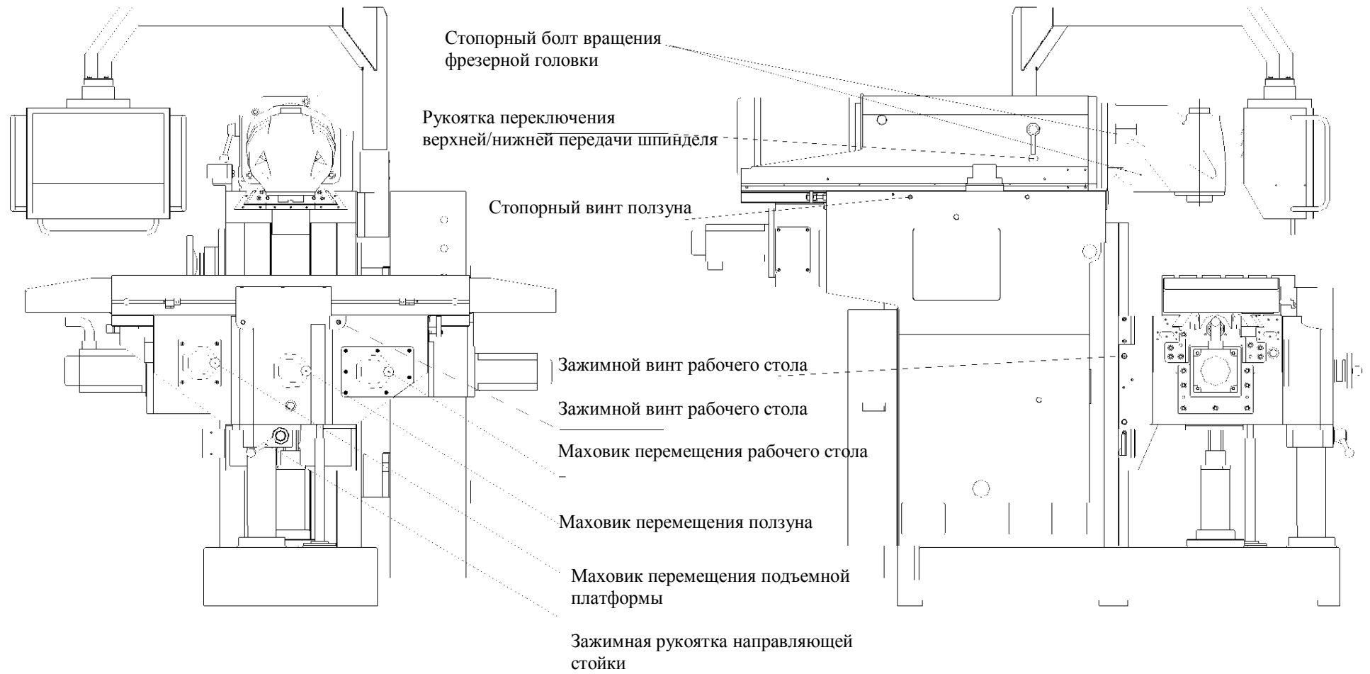
Рисунок 5. Схема расположения маховиков (рукояток)
