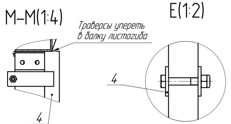
После настройки углового рычага положения болт затянуть
