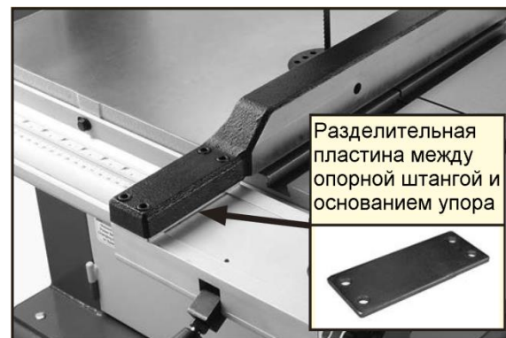
Рисунок 2. Установленная опорная штанга.
