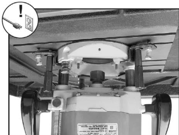
Рис. 13. Фрезер прикреплен к фрезерному столу.
