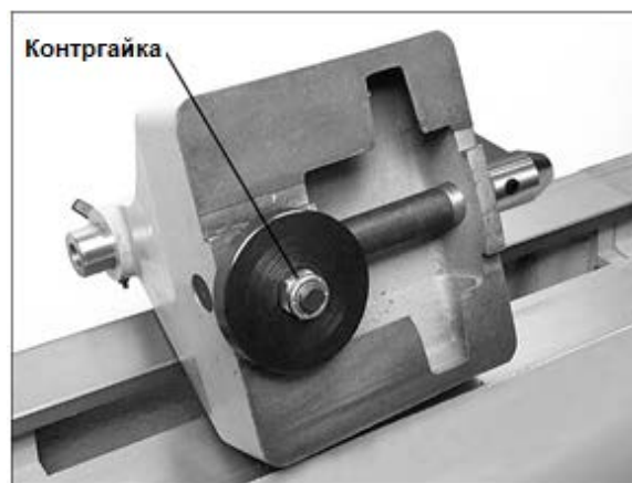
Рис. 8-2: регулировка зажимного эксцентрика
