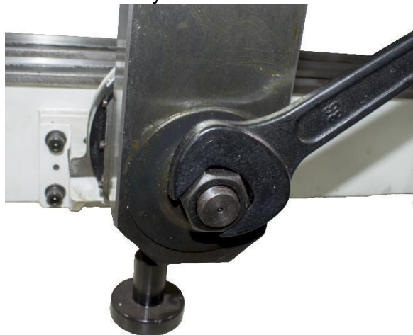
Рис. 35 Гайка фрезерной приставки Для изменения угла наклона стойки необходимо, надёжно удерживая фрезерную приставку, отпустить гайку сзади, ключом из набора. После установки нужного угла хорошо затянуть гайку.
