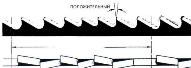
Этот тип пильного полотна больше всего подходит для распила профилей и больших труб с толстыми стенками, а также цельных прутков максимально допустимых для станка размеров. Возможные величины шагов: 3-4/4-6.
