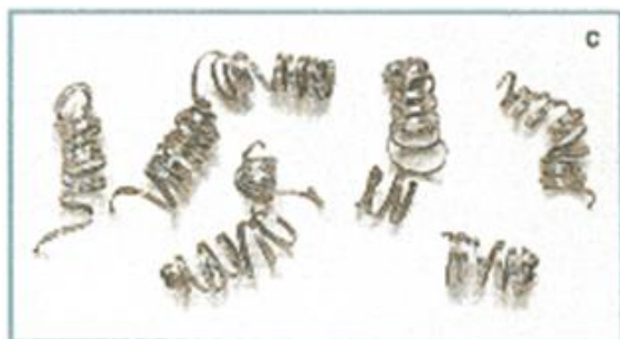
Свободно намотанная (витая) стружка - идеальные условия резания
