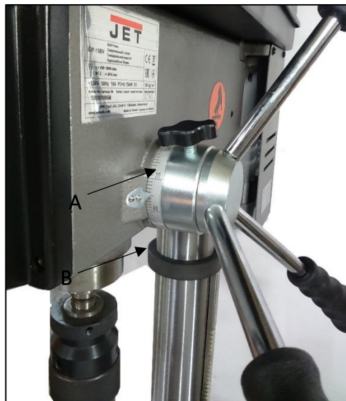
Рисунок 8-1. Регулировка ограничителя глубины сверления
