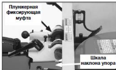
Рис. 45 Установка упора в положение 90°
