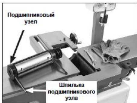
Рис. 56 Снятый ножевой вал
