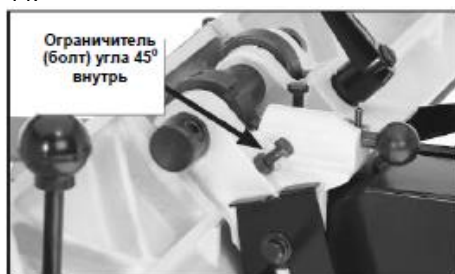
Рис. 44 Ограничитель упора для работы под углом 45° внутрь
