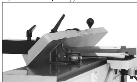
Рис. 43 Упор наклонен под углом 45° внутрь
