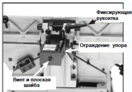
Рис. 12 Ограждение упора установлено
