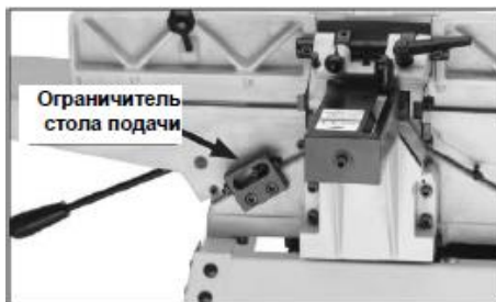
Рис. 19 Жесткие ограничители стола подачи
