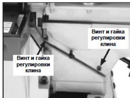
Рис. 47 Винты и контргайки клиньев стола
