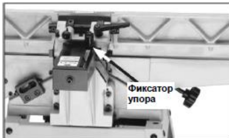
Рис. 20 Расположение фиксатора упора
