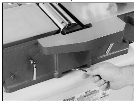
Рис. 55 Снятие гайки и стопорной шайбы
