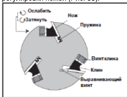
Рис. 38 Ножевой вал в разрезе
