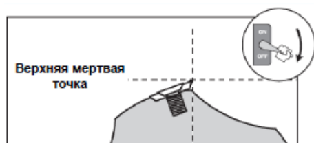
Рис. 62 Режущая пластина в ВМТ
