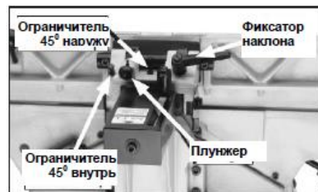
Рис. 21 Расположение жестких ограничителей упора
