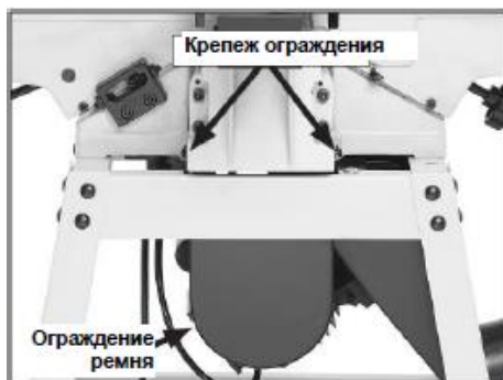
Рис. 9 Ограждение ремня установлено
