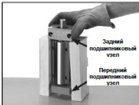
Рис. 57 Снятие заднего подшипникового узла
