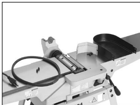
Рис. 48 Разборка фуговального станка
