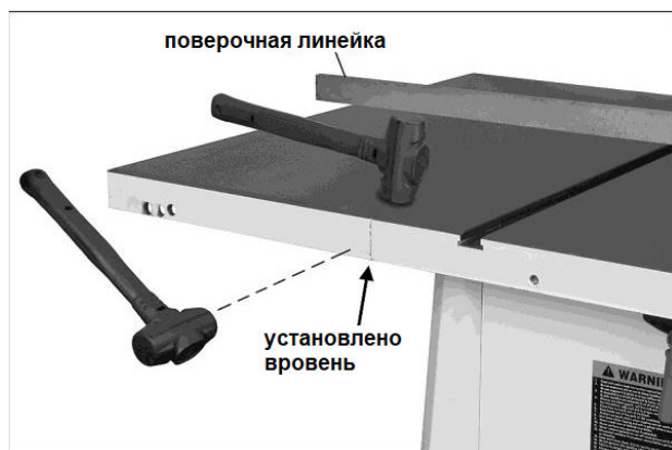
Рис. 5-5: выравнивание удлинений стола, способ 1
