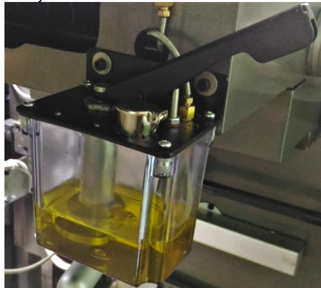
Рис. 25 Насос смазки стола
