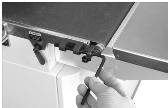
Рис. 8-3: регулировка натяжения ленты
