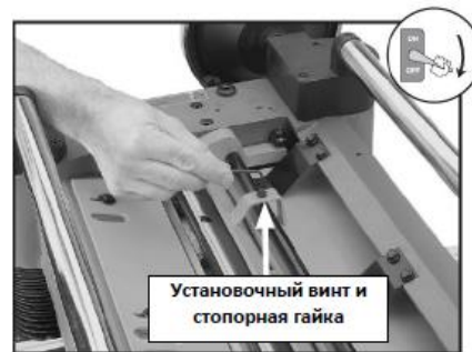
Рис. 25 Регулировка высоты стружколомателя
