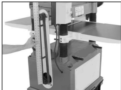
Рис. 30 Проверка правильности положения шкивов
