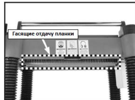
Рис. 29 Гасящие отдачу планки (гребенка)
