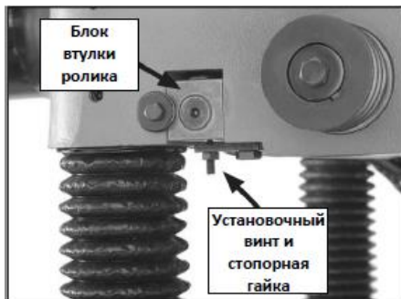
Рис. 24 Блок втулки ролика подачи и регулировка высоты
