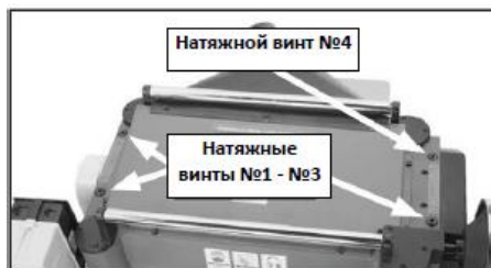
Рис. 26 Виты для регулировки натяжения пружин роликов
