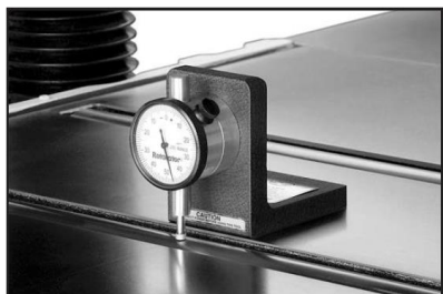
Рис. 22 Инструмент для точной регулировки станка Rotacator
