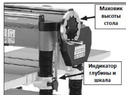
Рис. 12 Индикатор глубины резания и шкала
