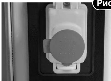
Крышка кнопки аварийного останова, для остановки станка стукните по крышке.
