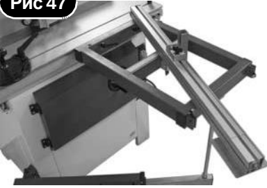
Упор рамы удлинения стола, установленный под углом 45°
