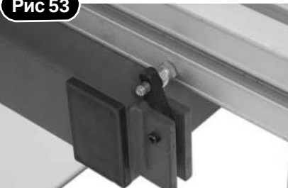
Ограничитель удлинения стола под углом 90°
