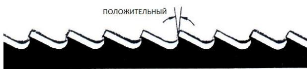
Используется для поперечного или наклонного распила цельных заготовок или больших труб, но прежде всего для твердых материалов (высоколегированные и нержавеющие стали, специальная бронза и ковкий чугун).
