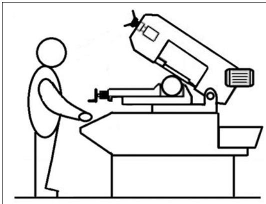
Перед началом каждой операции убедитесь в том, что заготовка надежно закреплена в тисках и конец заготовки поддерживается должным образом.
