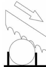
**ВНИМАНИЕ:** Всегда устанавливайте на станок пильное полотно с размерами, указанными в данной инструкции, и для которого настроены направляющие блоки. В случае установки пильного полотна другого размера см. пункт 5.2 Регулировка хода пильного полотна на шкивах и в направляющих блоках
