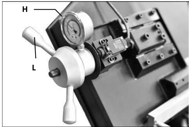
**Регулировка натяжения полотна без использования датчика контроля натяжения (Н):**
