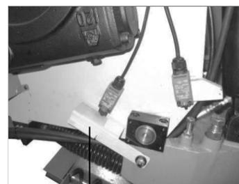
Пластина для регулировки высоты подъема пыльной рамы.
