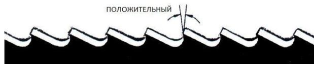
Используется для поперечного или наклонного распила цельных заготовок или больших труб, но прежде всего для твердых материалов (высоколегированные и нержавеющие стали, специальная бронза и ковкий чугун).
