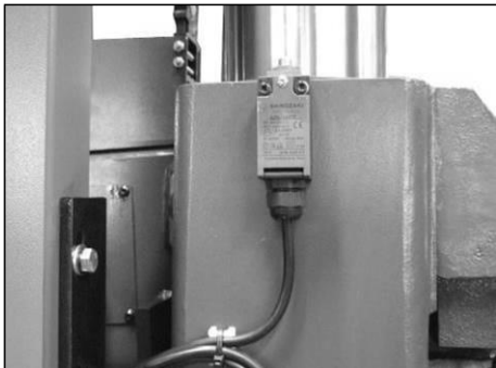
Верхний концевой выключатель высоты пилы.
