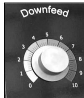
Регулятор подачи вниз – устанавливает скорость подачи пильной рамы в момент резания.
