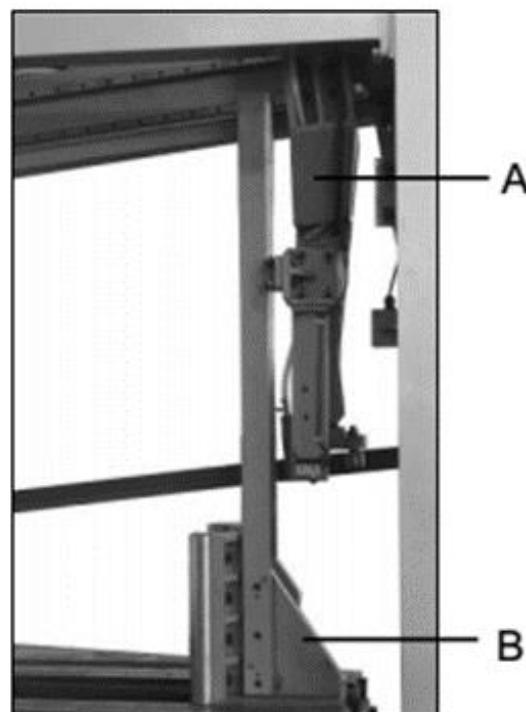
При перемещении в крайнее заднее положение сработает защитный переключатель.
