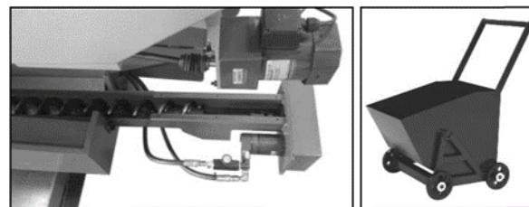
Шнек запускается автоматически при резке. Он управляет гидроприводом и передаёт стружку в тележку. Тележка легко перемещается для утилизации стружки.
