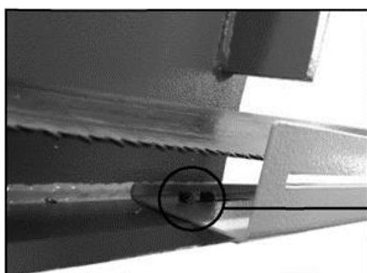
Ослабьте твердосплавную направляющую.
