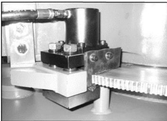
После установки положения бабки это положение фиксируется гидравлической системой.
