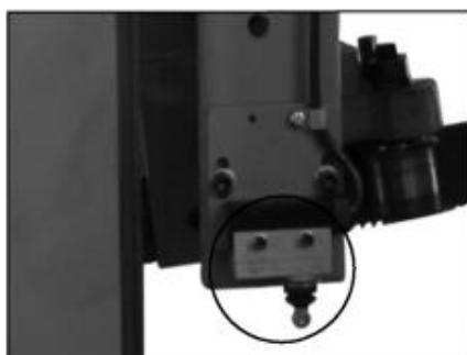
Устройство ограничения нижнего перемещения настраивается для остановки перемещения при контакте выключателя с пластиной.
