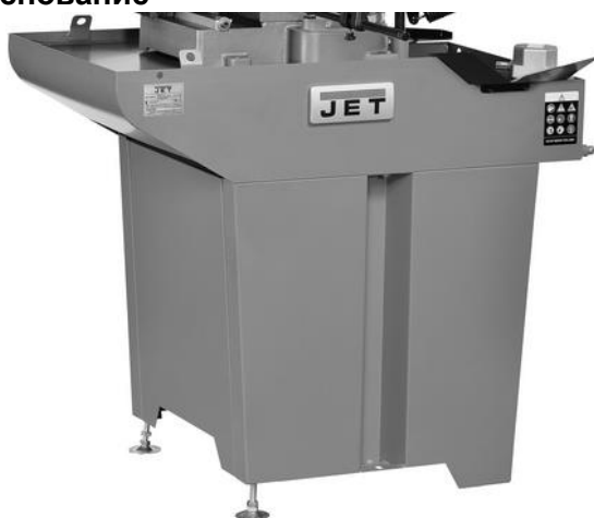
Рисунок 8 Основание поддерживает пильную раму, тиски, концевой упор, суппорт заготовки, охлаждающий насос, поворотную руку и сливные пластины охладителя. В корпусе основания расположена емкость для охлаждающей жидкости.
