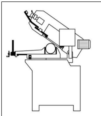
Перемещайте станок в транспортировочной таре, используйте вилочный погрузчик.
