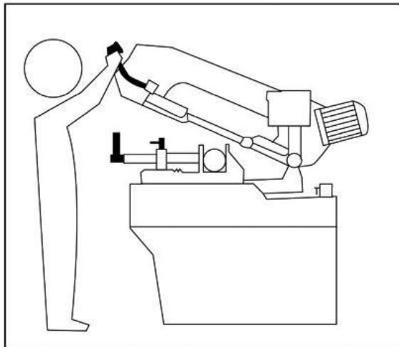
Перед началом каждой операции резки убедитесь, что деталь надежно закреплена в тисках, а конец надежно зафиксирован.
