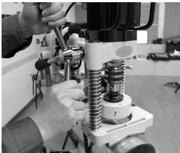
Процесс врезки отверстия
