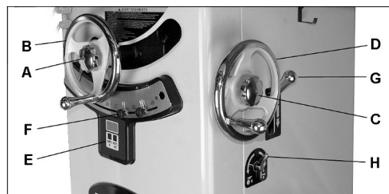
Рис. 8-1: Регулировка положения пильного диска
