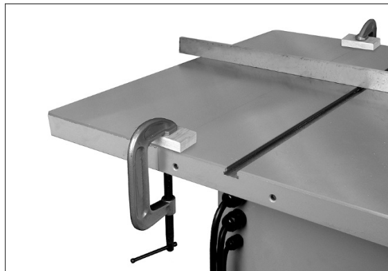
Рис. 6-5: Выравнивание удлинений стола, способ 2
