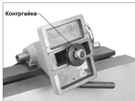
Рисунок 8-3: регулировка зажимного эксцентрика
