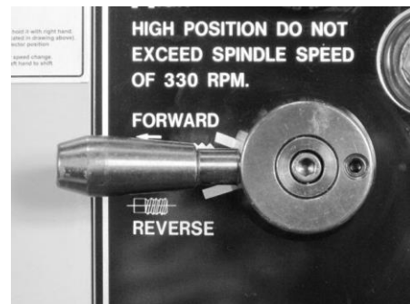
Рис. 18. Рукоятка выбора направления подачи Вперед (Forward)/Назад (Reverse)
