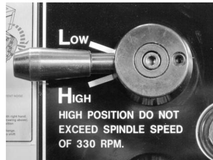
Рис. 17. Рукоятка выбора частоты коробки скоростей.
