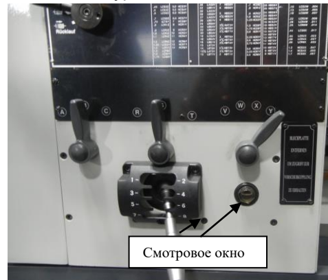
Рис. 74. Расположение смотрового окна коробки скоростей.
