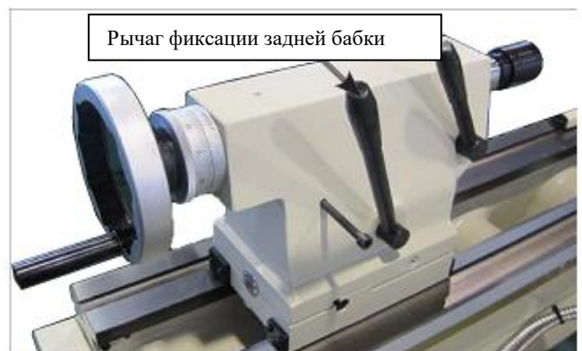
Рис. 9. Рычаг фиксации задней бабки.
