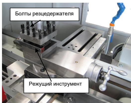
Рис. 42. 4-х позиционный резцедержатель.
