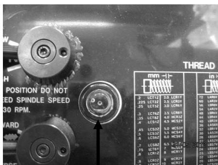
Рис. 23. Смотровое окно масляного насоса.
