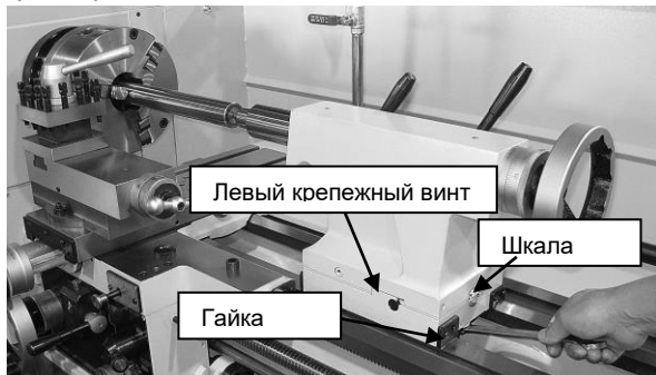
Рис. 35. Регулировка смещения задней бабки.
