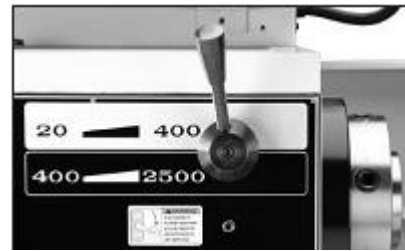
Рис. 16. Рукоятка переключения диапазонов передней бабки.
