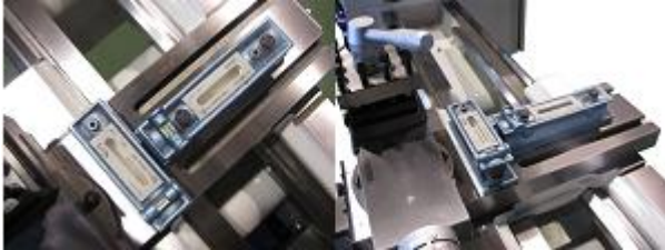
Рис. 14. Пример точного уровня
