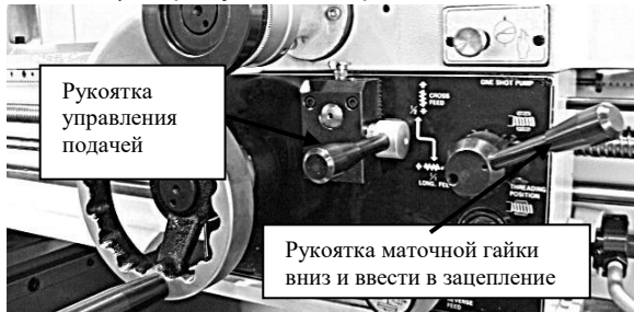
Рис. 54. Установка элементов управления кареткой для нарезания резьбы
