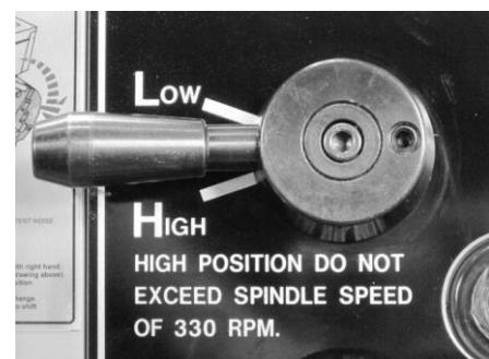
Рис. 24. Рукоятка переключения диапазонов
