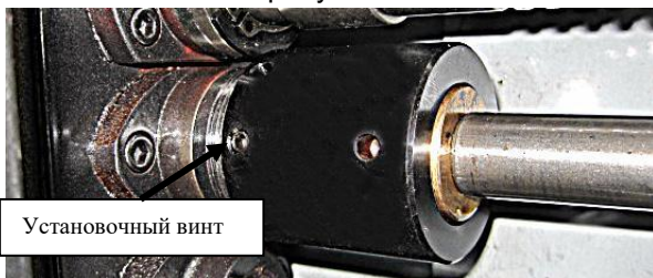
Рис. 95. Удаление установочного винта из ободка муфты.
