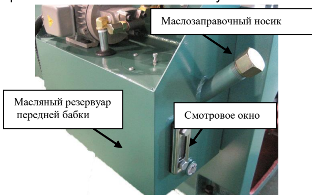
Рис. 70 Масляный резервуар передней бабки и его элементы.
