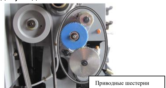
Рис. 83. Расположение приводных шестерен, которым требуется смазка.
