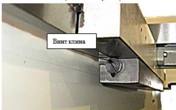
Рис. 90. Один из двух винтов заднего клина салазок.
