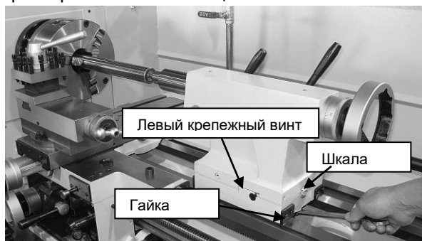
Рис. 35. Регулировка смещения задней бабки.
