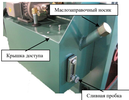
Рис. 72. Расположение элементов масляного резервуара передней бабки.
