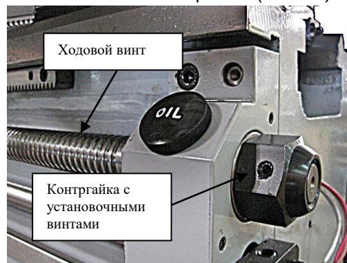
Рис. 88. Регулировка люфта ходового винта
