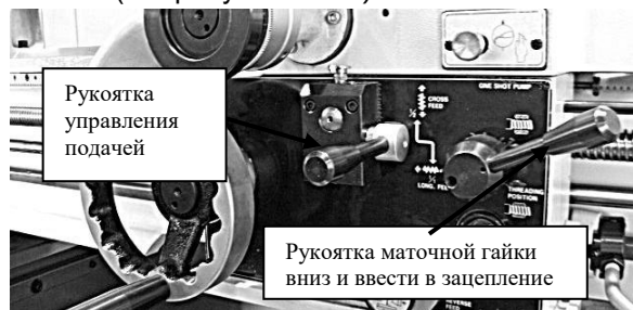
Рис. 54. Установка элементов управления кареткой для нарезания резьбы
