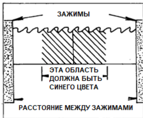
Правильные условия отжига жестких полотен из углеродистой стали
