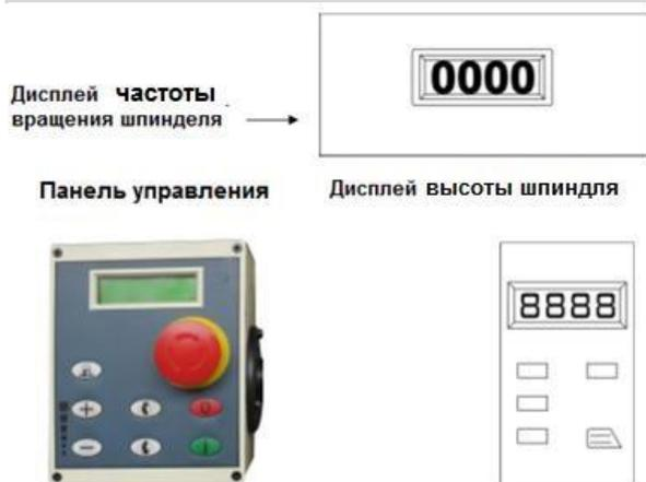
1. Вставьте штепсельную вилку в розетку. Затем сбросьте аварийный переключатель путем поворачивания красной круглой головки выключателя. Загорится дисплей частоты вращения шпинделя, значит питание включено.
