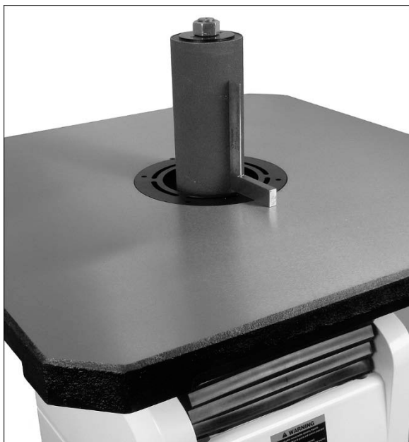
Рис. 13: настройка упора наклона стола
