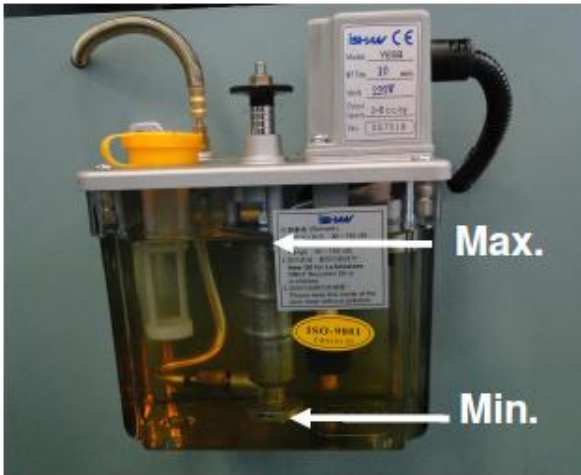
Рис. 3 – Автоматический масляный насос
