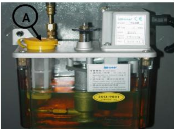
Рис. 5 – Автоматический масляный насос
