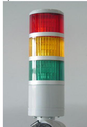
Рис. 7 – Индикаторная лампа режима станка
