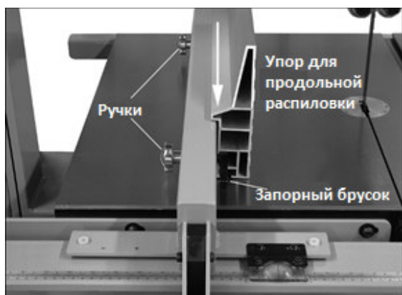
Рис. 8: вертикальное положение упора
