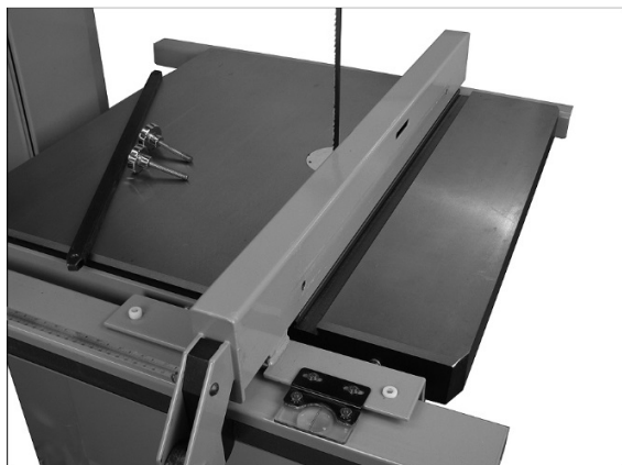
Рис. 15: установка упора параллельно ленточной пиле
