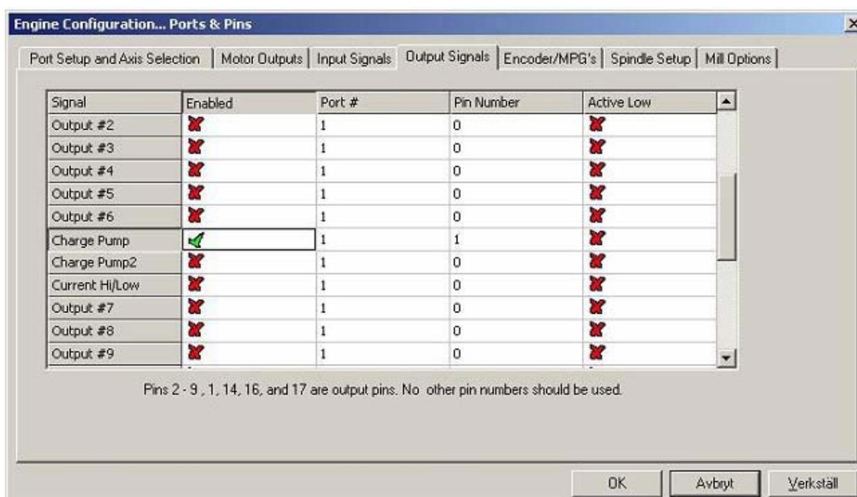
Рисунок 9: Сигналы выводов (Output Signals).
