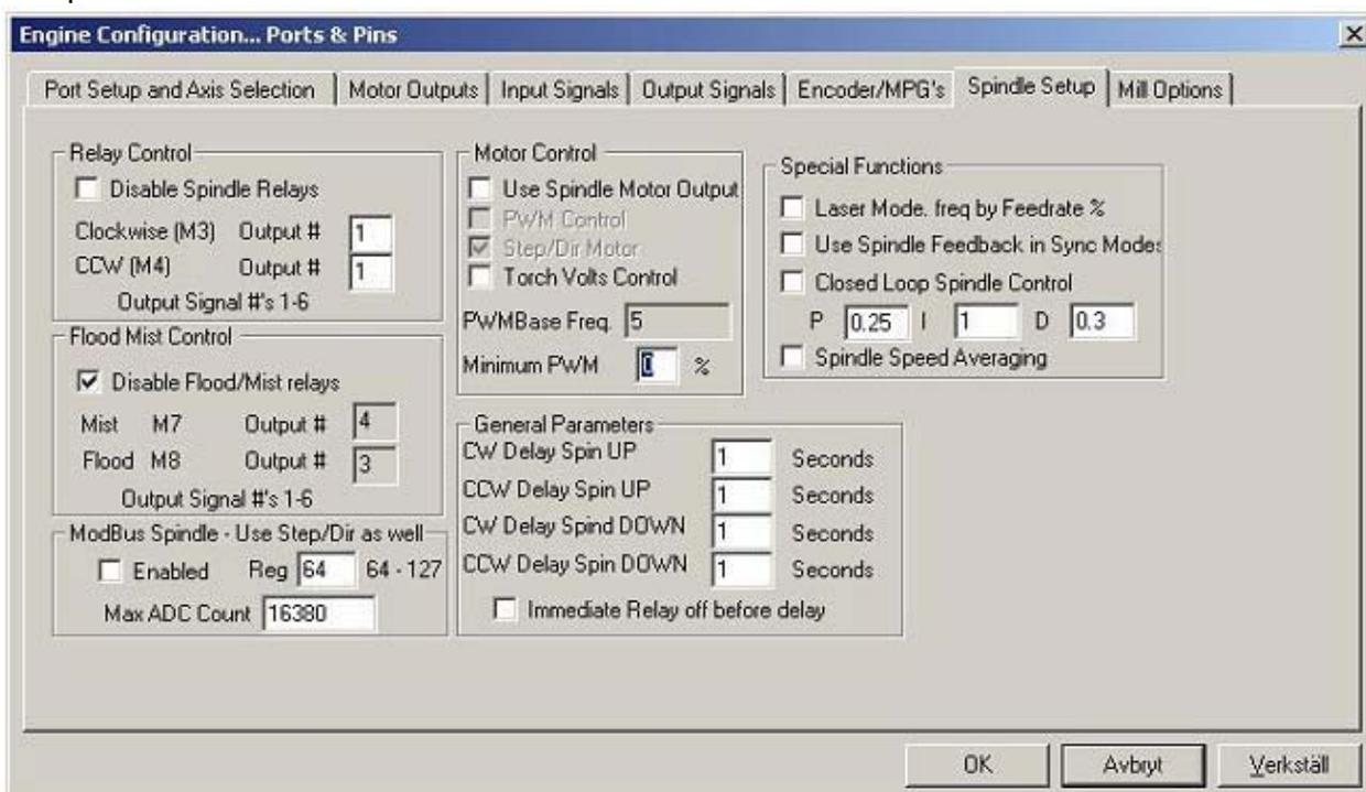
Рисунок 10: Диалог Spindle Setup (настройка шпинделя).
