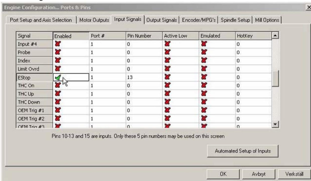
Рисунок 5: Настройка двигателя, вкладка Input Signals.
