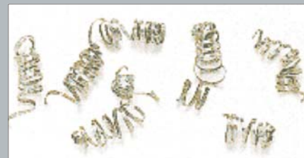
Свободно намотанная (витая) стружка - идеальные условия резания
