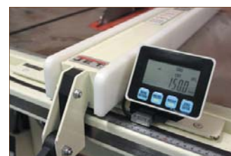
Цифровая индикация ширины распила (опция)
