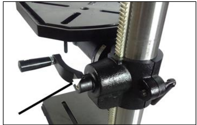
Рисунок 6-1: Установка коленчатой рукоятки
