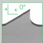
Форма зуба S передний угол зуба 0°
