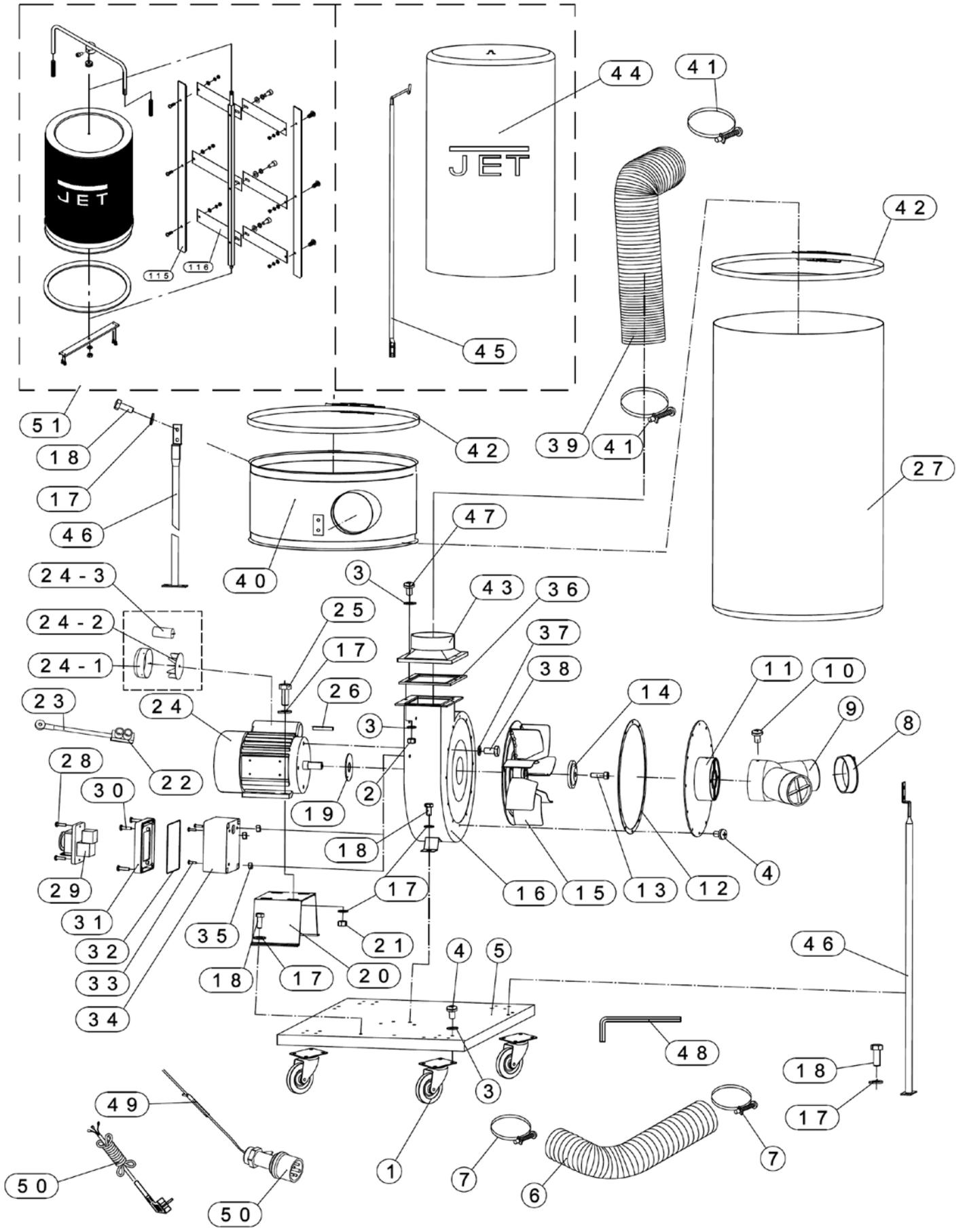
Перечень деталей для вытяжной установки DC-1200/DC-1200CK
