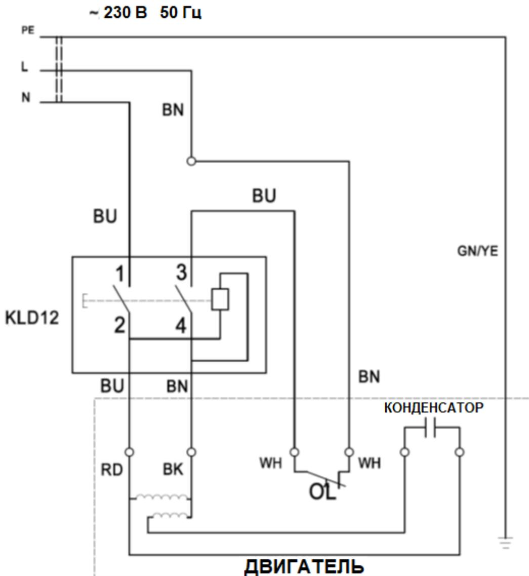
Электрическая схема для вытяжной установки DC-1200/DC1200СК
