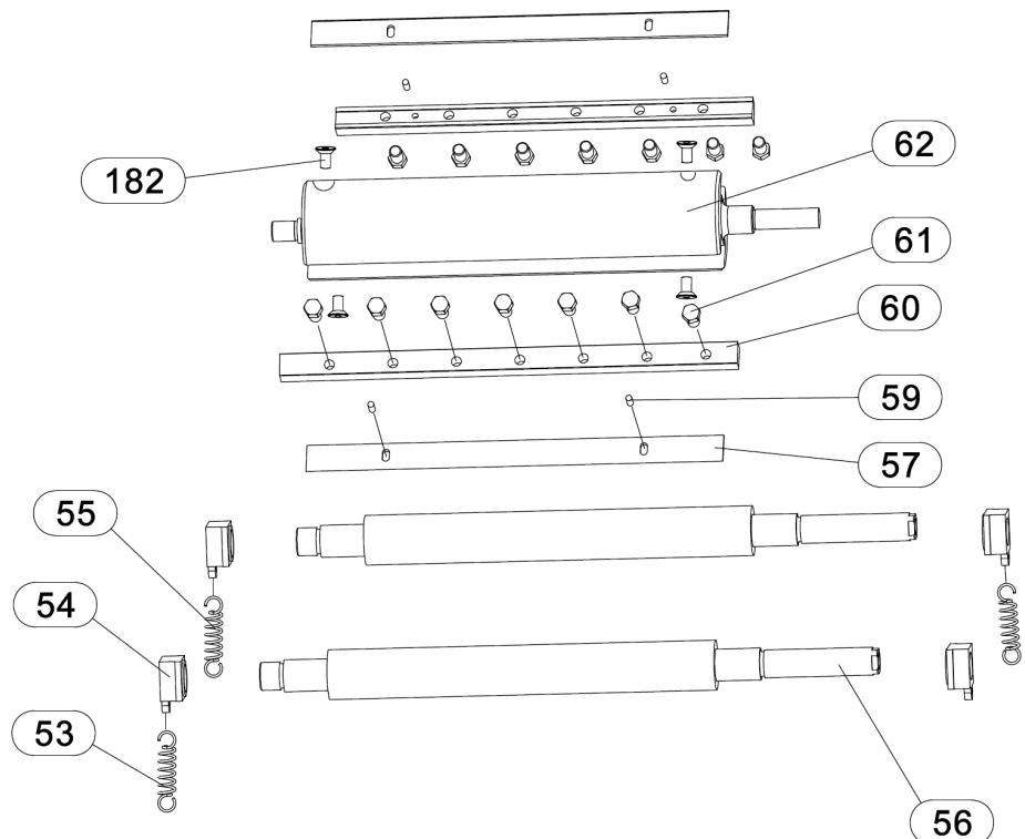
**Деталировка упора для фугования станка JPT-10B**
