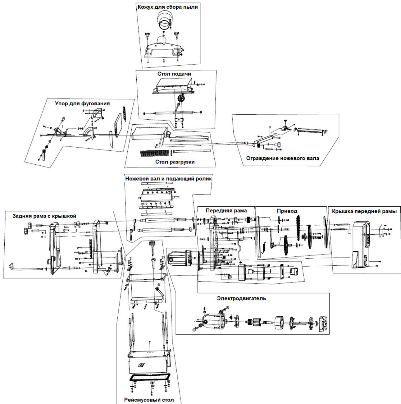
**Деталировка рейсмусового стола станка JPT-8В**
