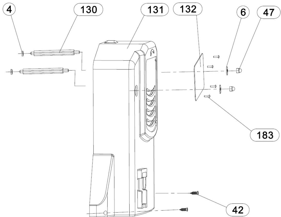
**Деталировка ограждения ножевого вала станка JPT-8B**
