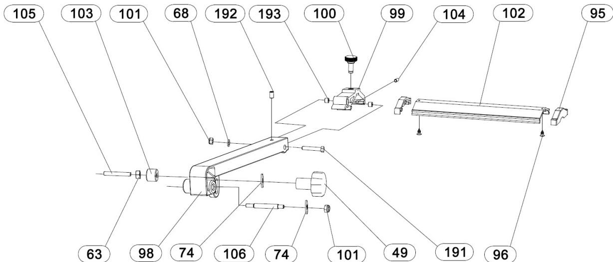
**Деталировка кожуха для сбора пыли станка JPT-10B**
